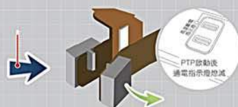
當溫度達150度左右 PTP裝置啟動，中斷電流
